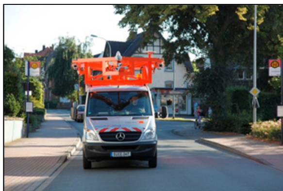
Abb. 3: Vermessungssystem Eagle Eye
